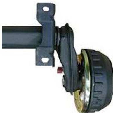
Exemple d'une platine d'un essieu freiné standard
